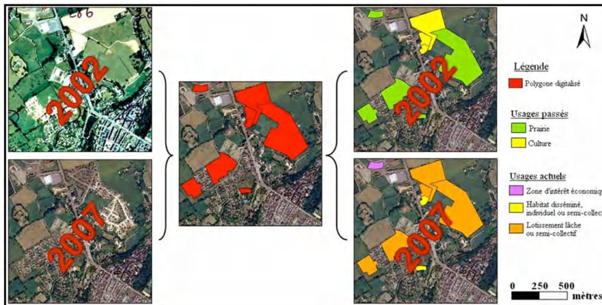
Il s'agit de superposer et de comparer des photo-aériennes (orthophotoplans géolocalisés et géoréférencés) prises à 2 dates différentes avec un logiciel de cartographie sur ordinateur (logiciel SIG de type Geoconcept ou Arcview par exemple).
